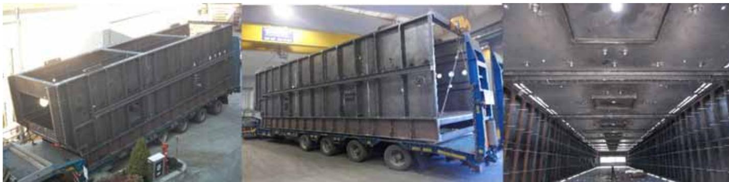
Realizzazione, sulla base dei progetti e dei disegni forniti dal cliente, di **forni a tenuta multi camera.**
